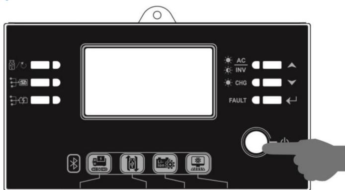
Poté, co byl přístroj správně nainstalován a byl připojen k baterii, stiskněte jednoduše tlačítko On/Off pro zapnutí přístroje. Tlačítko je umístěno na LCD displeji.
